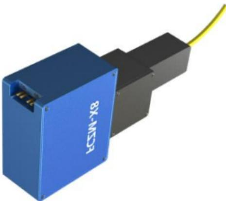
光电分离照明光源系统是通过光电模组将电能转化为光能后通过光纤将光能传导至路灯出光端的反射器内, 有效实现了光和电的分离, 充分发挥光电分离照明光源的作用, 使得路灯不带电只能输出光能, 无电流通过, 以达到对人体无触电隐患, 光电分离照明电源系统提高了更换或维护的便捷性, 出光端无电火花产生, 无电磁干扰, 不产生热量从而不会影响周围环境, 光电分离照明光源系统在建筑方面也有很好的应用, 使用光的重点照明来达到凸显建物轮廓线的效果, 光电分离照明光源整体照明的维护成本可以有效的降低, 因为光纤本体的寿命长达二十年, 而光电分离照明光源可以设计在内部设备里, 维护的人员可以轻易的进行光电分离光源的维护更换, 而传统照明设备得动用许多机器设施才能进行维护, 成本的预算就比光电分离照明光源系统高出很多。
